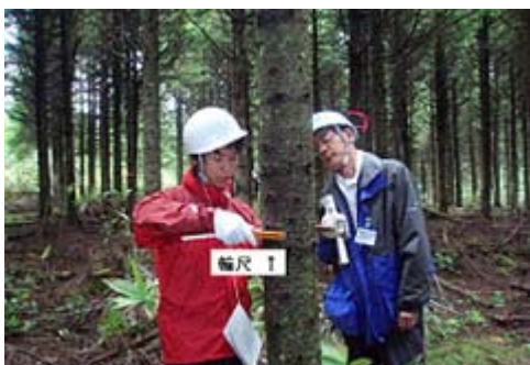
輪尺で胸高直径測定
