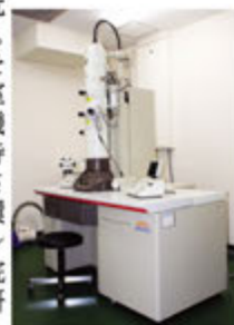
6号館機器室に設置された透過型電子顕微鏡
