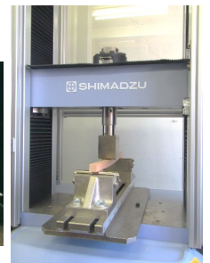
木材曲げ試験の様子 (木材計測学実験で実施予定)
