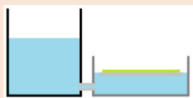
②①に雨水を貯める 装置を設置したもの
