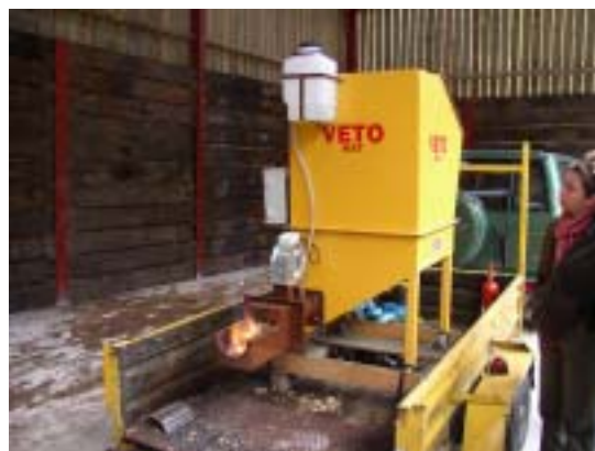
写真6 チップボイラーのデモンストレーション
